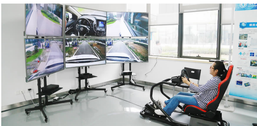
驾驶员坐在实验室内,通过车联网远程驾驶室外的汽车
